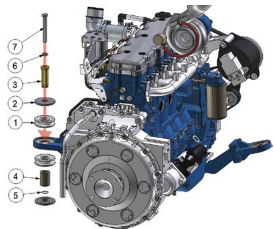
Beispiel für eine Explosionsdarstellung in Solid Edge 3D Publishing
